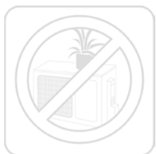
確保室外機進氣口和出氣口沒有雜物阻塞
